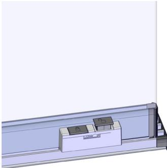
A: Unterer Riegel, kann mit einem Schloss ausgestattet werden
